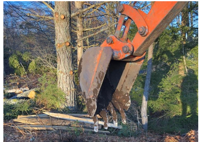
Godet à dents utilisé pour casser les rhizomes de fougère aigle
